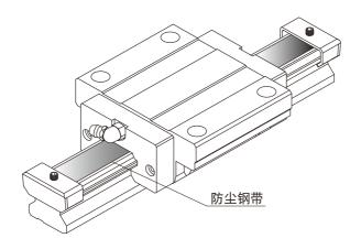
注:为安装防尘钢带,导轨需进行铣沟加工,而标准型防尘钢带不会增加组装后之导轨高度。
